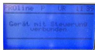
In dem Moment, in dem sich das Gerät mit der PROline Steuerung verbunden hat, erscheint auf dem Steuerungs-Display die entsprechende Anzeige
