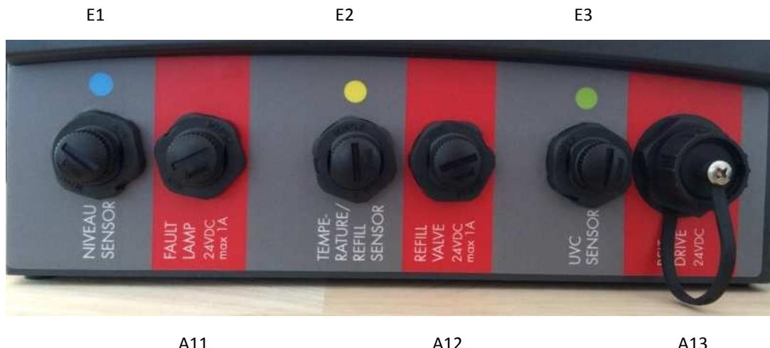
Die Eingänge der Steuerung sind farblich gekennzeichnet, ebenso wie die entsprechenden Leitungen der Sensoren. Die Leitungen werden entsprechend der farblichen Kennzeichnung angeschlossen und mit der Kontermutter am Stecker festgezogen.
